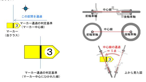
4) マーカーの破損、マーカーを落とす、コーステープを切断する等、セクションの修復が必要となった場合は5点とする。
